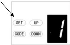
a) Mantenga presionado el botón **SET** hasta que aparezca "1" en la pantalla, luego presione el botón **UP** hasta que aparezca "7" en la pantalla para ingresar a esta configuración de función y luego suelte el botón.
