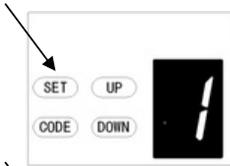
a) Mantenga presionado el botón **SET** para ingresar esta configuración de función hasta que aparezca "1" en la pantalla y luego suelte el botón
